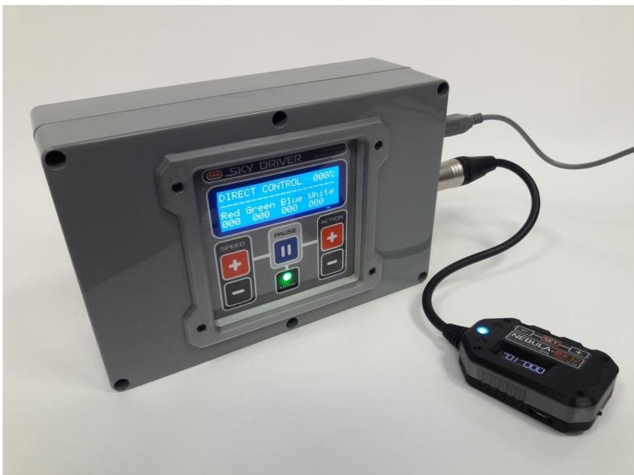
Светодиодный контроллер предназначен для управления индивидуально-адресуемыми светодиодами RGBW, а также RGB с любыми типами микросхем. Наличие в составе светодиода источника чистого белого света (W), расширяет диапазон воспроизводимых оттенков цвета в область, недоступную для традиционных RGB-светодиодов.
